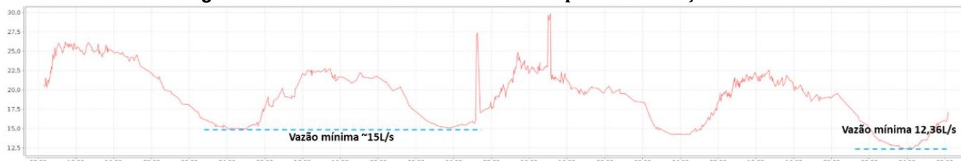
Figura 74: Vazão mínima noturna antes e depois da instalação da VPR.
